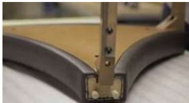
座に革を張り、構造体となる金属フレームを取り付け
