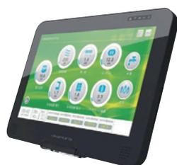
「消費電力見える化システム STORE NAVI(ストアナビ)」は、照明や冷凍設備動力など項目別に電力消費量を表示し、店舗のエネルギー使用状況を「見える化」するシステムです。計測データをグラフ
