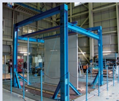
「フロヴァート」の耐震性能評価試験
