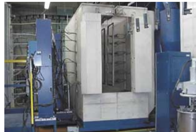
追浜サイトに導入した粉体塗装ラインとカートリッジ方式塗料回収システム
