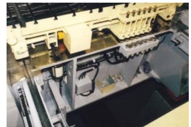
振動防止に配慮した床下構造
