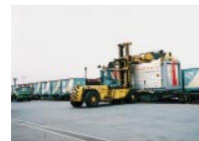
ターミナルに到着したコンテナを、コンテナ専用貨車に積み込みます
