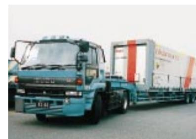
コンテナをターミナルに配送。背の高いロッカーなども積載できるよう、コンテナの高さを限界(2,790mm)まで上げた分、シャーシー(台車)の高さを下げて道路交通法に対応させています
