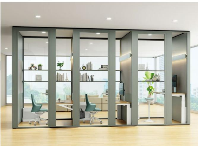
パーティションに設けたスリットを利用して、デスクや棚や照明をアタッチメントできます。これにより、デスクの脚や棚の柱などが削減でき、すっきりとした空間を構成できます。
