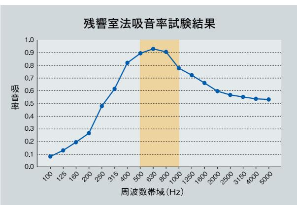
人の話し声に含まれる周波数帯域(500~1000Hz)の吸音率が概ね0.77~0.93と高水準の吸音性能を有しています。
