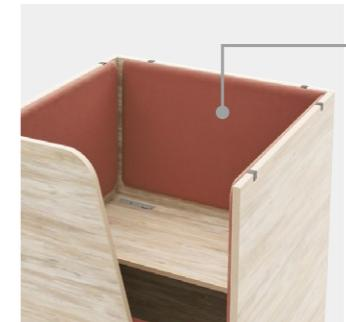
吸音パネル（オプション）を取り付けることも可能です。音の反響が軽減され、WEB会議により集中しやすい環境になります。吸音パネルは、人の話し声に多く含まれる周波数帯域（500～1000Hz）の吸音率が概ね0.6以上となっており、高い吸音性能を有しています。
