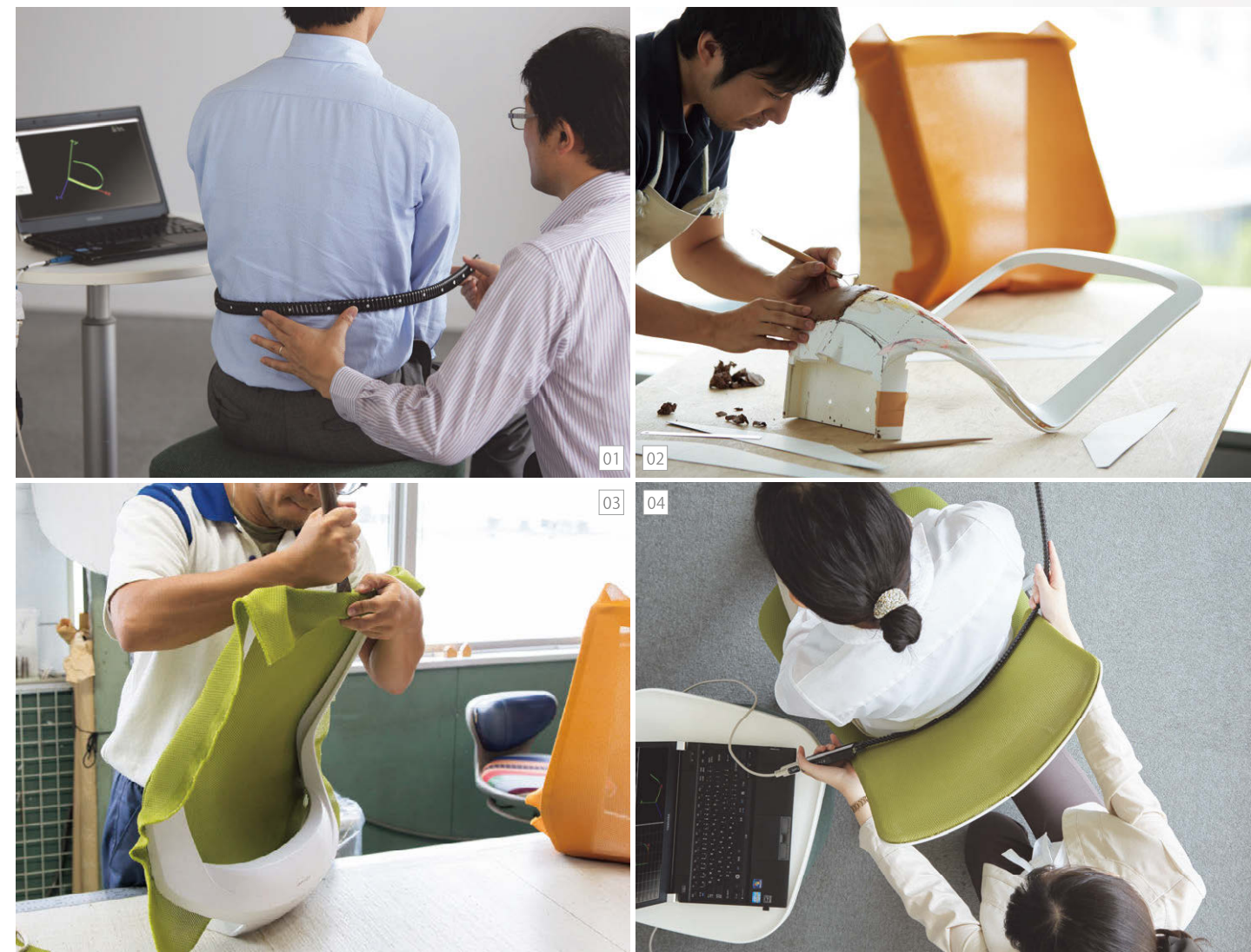
01 腰まわりの3次元形状計測 02 背フレーム形状のデザイン探求 03 メッシュ張り検証 04 試作品の3次元カーブとフィット感の検証
