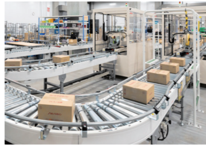
ピッキング後は封函機で梱包。出荷前の物の滞留を減らすことでセンター全体のスループットを向上。
