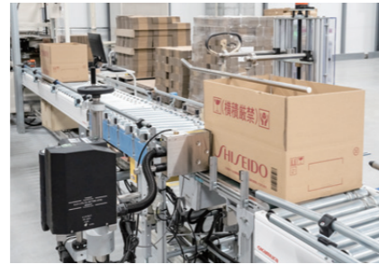
出荷作業の起点となる自動製函時にダンボールにバーコード印字し、オーダーを管理。
