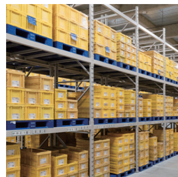
工場から入荷した商品は、パレットラックに格納され、必要なタイミングでロータリーラックHに補充されている。
