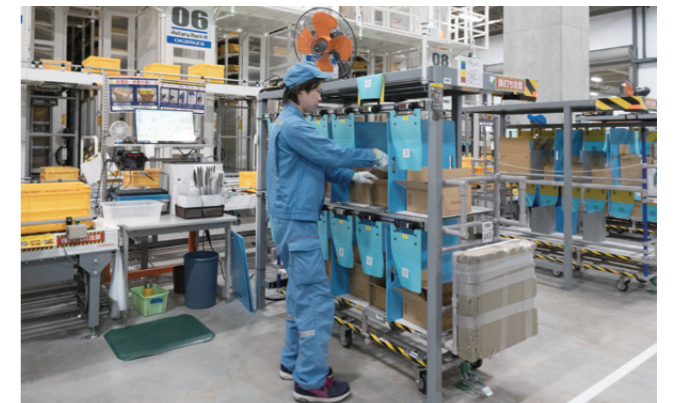
SAS(シャッターアソートシステム)を組み合わせたマルチピッキング方式で、一度の出庫で複数行の作業が可能。シンプルなオペレーションのため、物量が瞬発的に跳ねたときに初めての作業者が配置されても、すぐに作業ができる。
