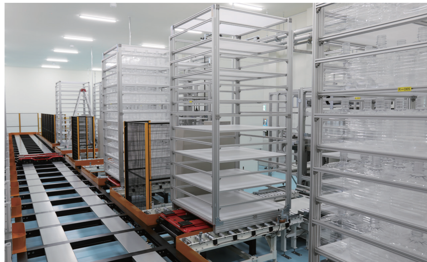
ペットボトル成型工程と天然水充填工程の間を調整するバッファ保管設備としてサイビスターIIを導入。専用ボトルラック(25本×7段=175本)で、最大23,000本のペットボトルのバッファ保管が可能です。
