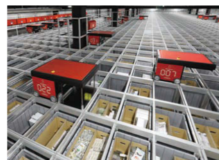
架台上: 広く浅く設計した保管エリアでは、国内最大規模の76台のロボットがポートまでスムーズに走行。
