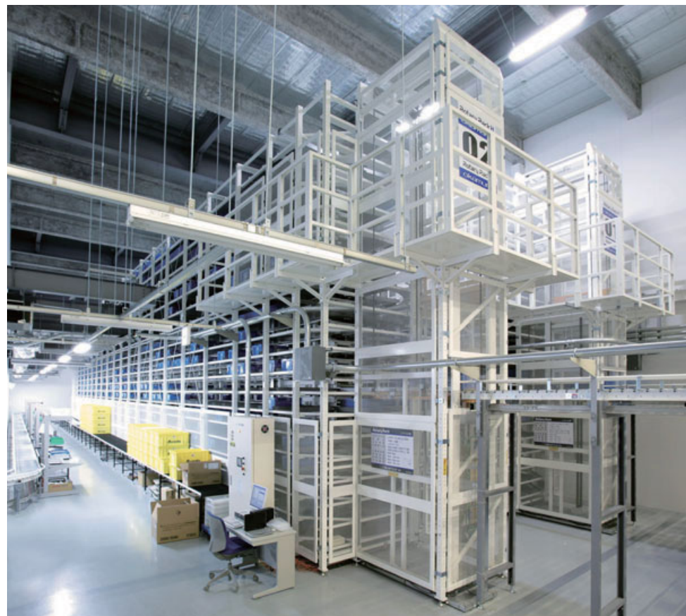
上 / 待機・整列自動倉庫 入庫側 （ロータリーラックH） 手前は3Fからの垂直搬送機 （バーチカルコンベヤ）
