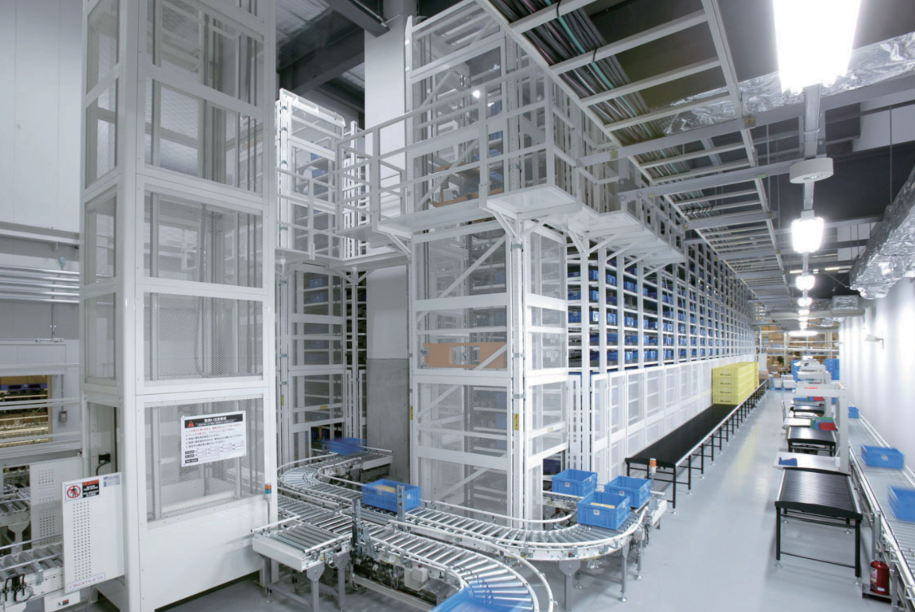
上 / 待機・整列自動倉庫 入庫側 （ロータリーラックH） 手前は3Fからの垂直搬送機 （バーチカルコンベヤ）
